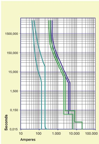
PremEon разработанный для выключателей Record Plus, имеющих уникальную селективность и токоограничивающую способность, предлагает значительно улучшенную селективность между вышестоящими и нижестоящими устройствами.
